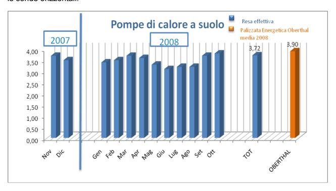
Media del COP effettivo delle pompe di calore a sonde della concorrenza testate
